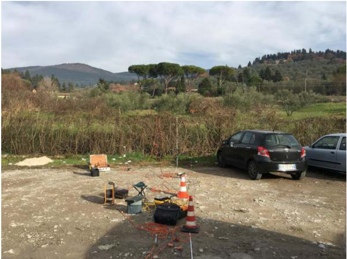
Figura 2: Fase di acquisizione della sezione sismica 1-1' presso Eli Lilly Spa.
